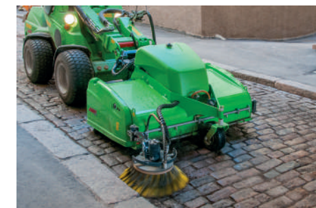
Barredora con recogedor 150 + cepillo lateral + sistema difusión agua
