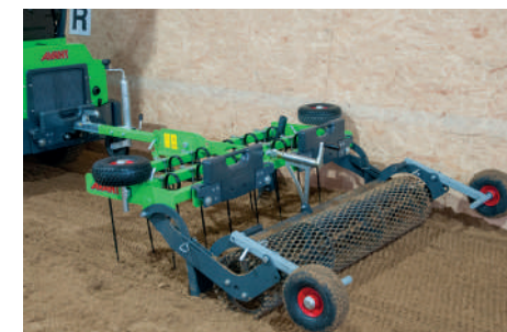
Escarificador de arena hípica + ruedas de transporte + difusor de agua
